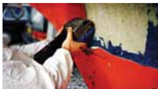
Borttagning av gelcoat
