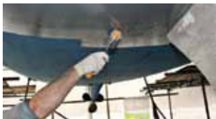
Applicera High Protect med rulle
